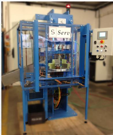
Nos machines stationnaires de soudage par résistance peuvent être équipées d'un plateau tournant. Polyvalentes elles sont adaptées aux points et aux bossages.
