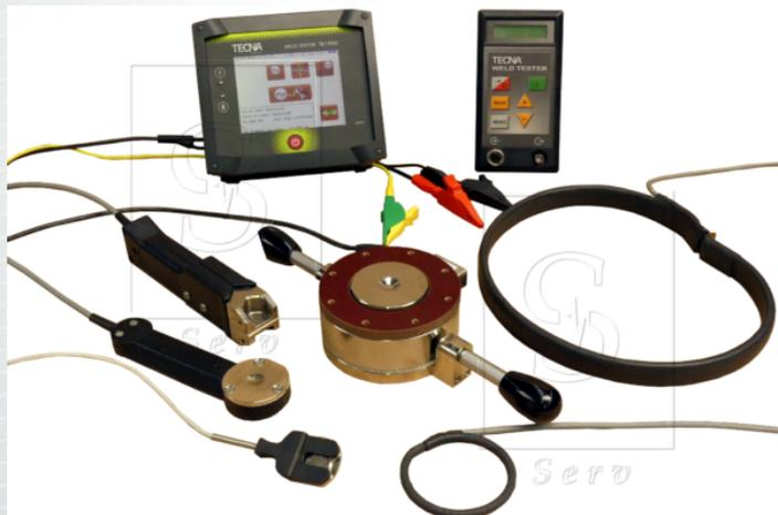
Nos appareils portable de mesures contrôlent les efforts, l'intensité, le temps de soudure et la tension des machines de soudure.
