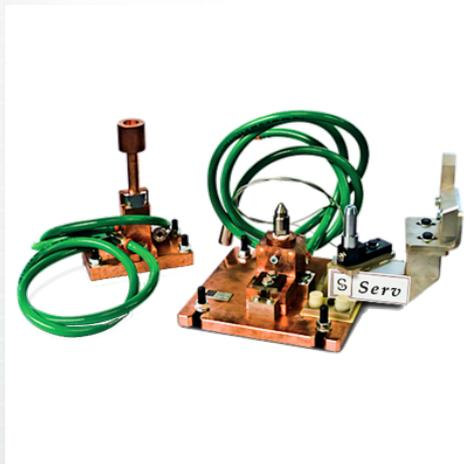
Nos outils de soudure d'écrous sont composés d'une plaque supérieure, d'une plaque inférieure, de portes électrodes et d'un pilote à fuite d'air.
